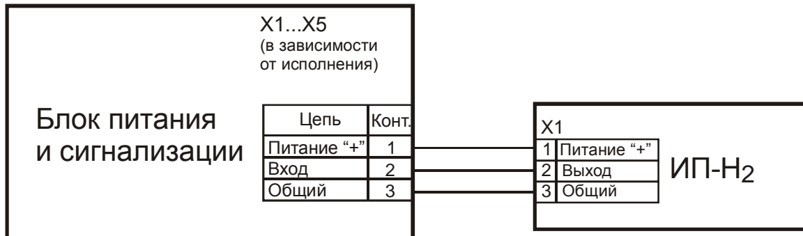
а) Схема подключения ИП-Н 2 :
